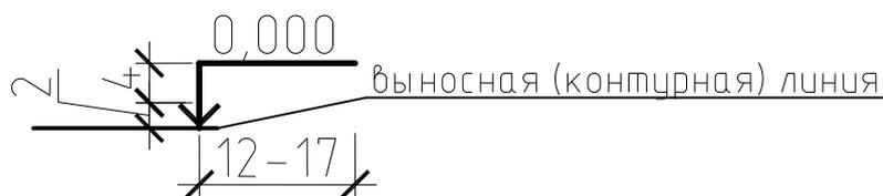
Рисунок 2 – Обозначение высотных отметок
